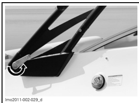
ESTIBORDO - GIRE O PUXADOR 3/4 DE VOLTA NA DIREÇÃO ANTI-HORÁRIA PARA TRAVAR
