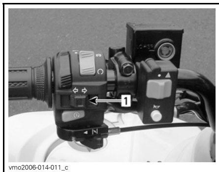
1. Reglage för riktningvisare
