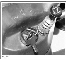
CHOKE LEVER IN THE FULL CHOKE POSITION
