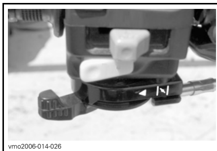
TIPICO — LEVA DEL DISPOSITIVO DELL'ARIA IN POSIZIONE FULL
