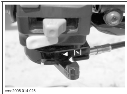
LEVA DEL DISPOSITIVO DELL'ARIA IN POSIZIONE OFF
