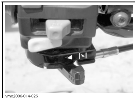
TIPICO — LEVA DEL DISPOSITIVO DELL'ARIA IN POSIZIONE OFF
