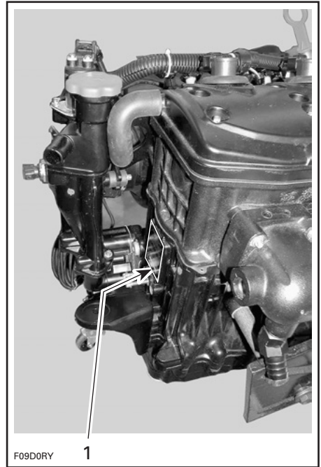
1. Número de identificación del motor (E.I.N.)
