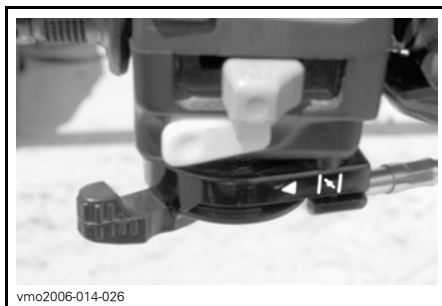
TYYPILLINEN — RIKASTINVIPU TÄYSIN PÄÄLLÄ -ASENNOSSA.
