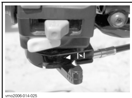
TYYPILLINEN — RIKASTINVIPU POIS-ASENNOSSA.
