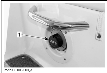
1. Interruptor principal de corte da bateria
