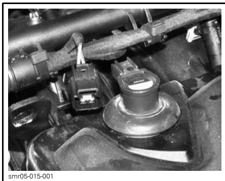
KOPPEL DE AANSLUITINGEN VAN DE ONTSTEKINGSSPOELN LOS
