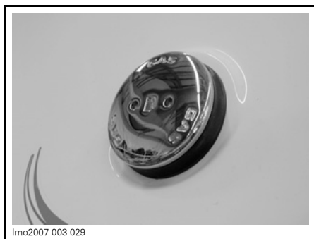
Imo2007-003-029 TAPÓN DEL DEPÓSITO DE COMBUSTIBLE
