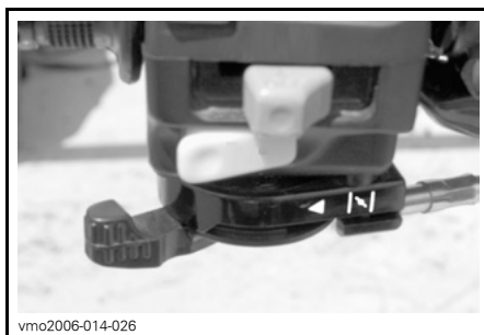
CHOKE IN VOLLSTÄNDIG GEÖFFNETER POSITION
