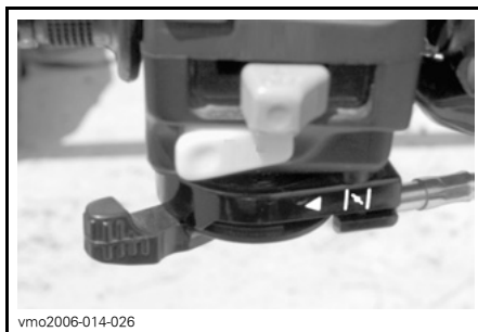
TYPISCH — CHOKE IN VOLLSTÄNDIG GEÖFFNETER POSITION (FULL)
