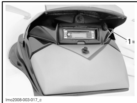
1. Tomada para acessórios 12 Volts
