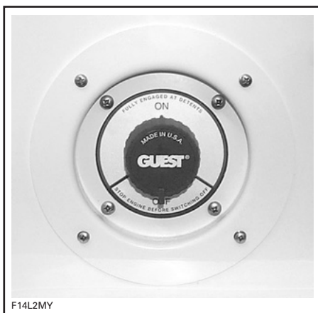
TÍPICO — INTERRUPTOR PRINCIPAL DE CORTE DA BATERIA
