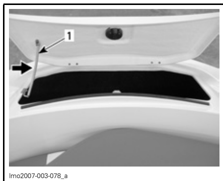
1. Spingere delicatamente sul lato della molla per rilasciarla
