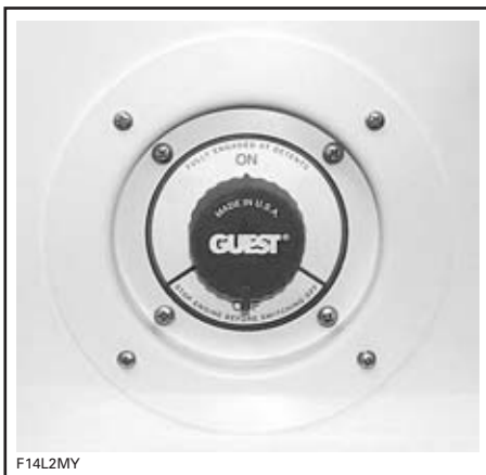
TIPICO — INTERRUPTORE BATTERIA PRINCIPALE
