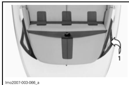
TIPICO 1. Condotto dell'aeratore
