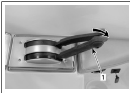
1. Leva del cambio in posizione di retromarcia
