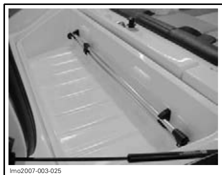
MODÈLES 230 CHALLENGER — FEU DE POUPE DANS LES PINCES DE RANGEMENT
