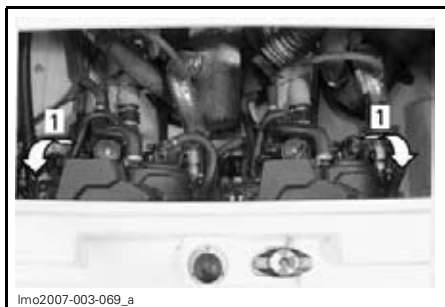
1. Emplacement des fusibles
