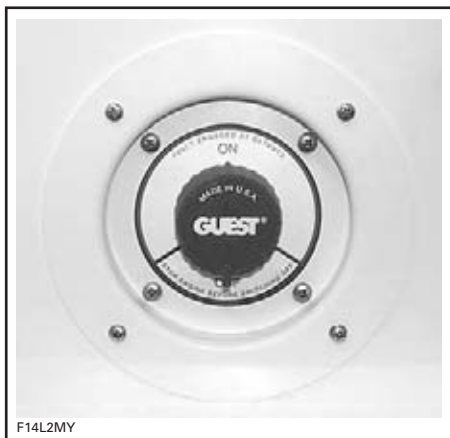
TYPIQUE — INTERRUPTEUR COUPE-CIRCUIT PRINCIPAL DE LA BATTERIE
