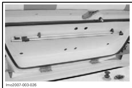
MODÈLES 230 WAKE — FEU DE POUPE DANS LES PINCES DE RANGEMENT
