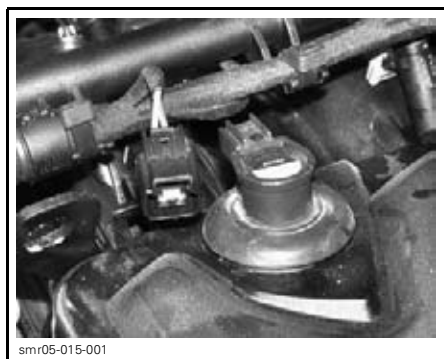
DÉBRANCHER LES CONNECTEURS DES BOBINES D'ALLUMAGE
