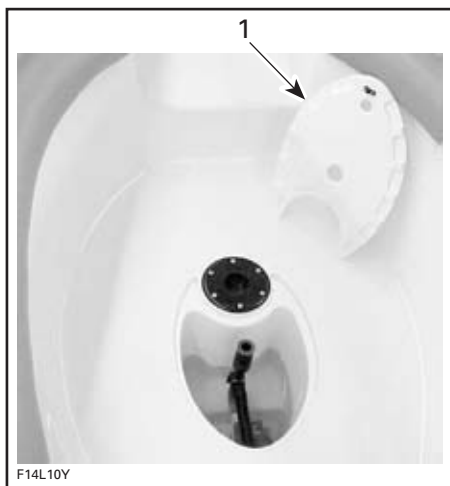
F14L10Y RETIRE LA TAPA DEL SUMIDERO DEL SURTIDOR
