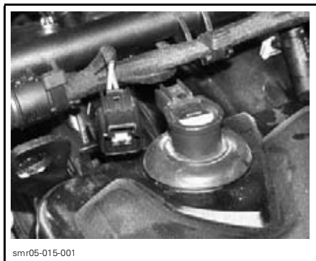
DÉBRANCHER LES CONNECTEURS DES BOBINES D'ALLUMAGE
