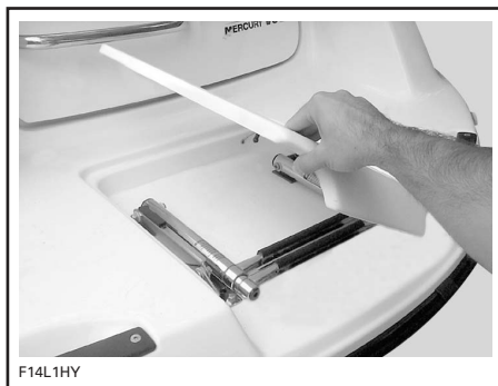
HEF HET DEKSEL OMHOOG TOT HET WORDT TEGENGEHOUDEN DOOR DE BORGVEER (VEER NIET AFGEBEELD)
