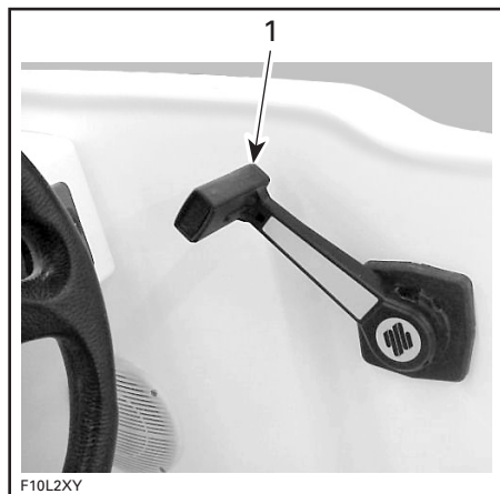
TÍPICO — POSICIÓN AVANTE A TODO GAS 1. Botón de palanca de aceleración/cambios
