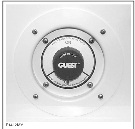
TÍPICO — INTERRUPTOR DE DESCONEXIÓN DE BATERÍA PRINCIPAL
