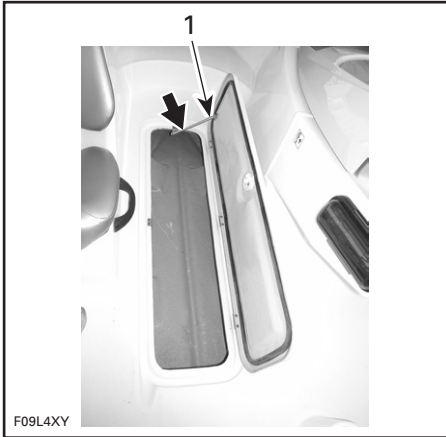
TYPISCH 1. Hier vorsichtig drücken, um die Feder zu lösen
