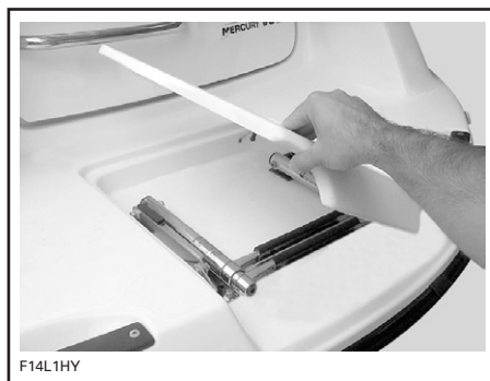
SOLLEVARE LA SCALETTA FINO A QUANDO SI BLOCCA MEDIANTE LA MOLLA DI TRATTENIMENTO (MOLLA NON ILLUSTRATA)
