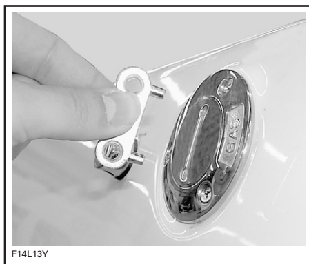
USARE LA CHIAVE DEL TAPPO PER SERBATOIO CARBURANTE
