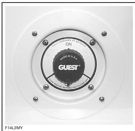
SITUAZIONE TIPICA — INTERRUPTORE BATTERIA PRINCIPALE
