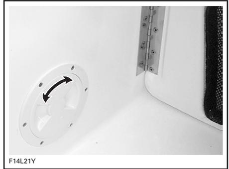
BEI BRAND IM MOTORRAUM KAPPE ENTFERNEN, DÜSE DES FEUERLÖSCHERS EINFÜHREN UND ABDRÜCKEN
