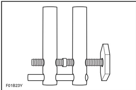
En bloquant ce boyau, on empêchera le système de refroidissement de se remplir, ce qui aurait pour effet d'injecter l'eau dans le ou les systèmes d'échappement et de les remplir. Lorsque le ou les moteurs ne sont pas en marche, il n'y a aucune pression sur le ou les systèmes d'échappement pour permettre à l'eau de s'échapper par la ou les sorties d'échappement.
