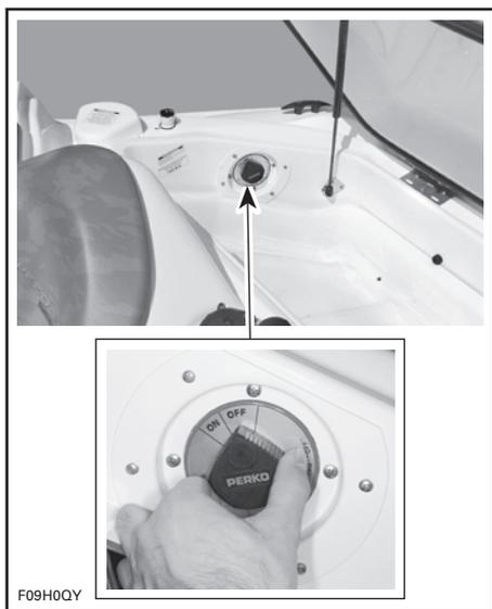
**TYPIQUE** — **INTERRUPTEUR COUPE-CIRCUIT PRINCIPAL DE LA BATTERIE**
