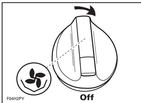
Cet interrupteur rotatif comporte deux positions («OFF» et VENTILATEUR). Lorsqu'on l'actionne, le ventilateur permet d'aérer le compartiment-moteur.
