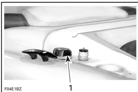
1. Bouchon du réservoir d'huile à injection
