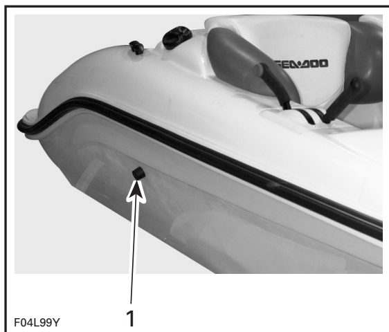
1. Aération du réservoir de carburant
