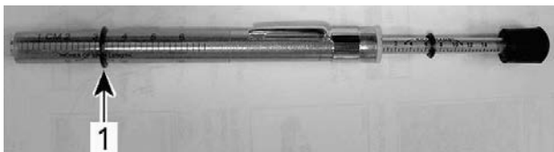
1. Joint torique inférieur
