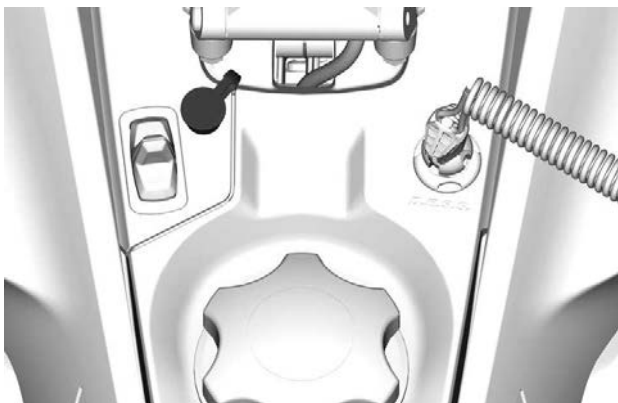
KULJETTAJAN SÄHKÖISEN VISIIRIN JAKKILIITTIMEN SIJAINTI
