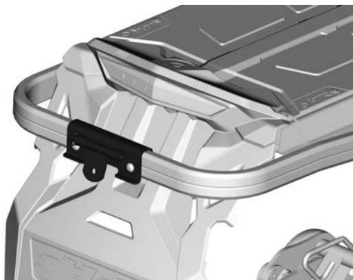
Сцепное устройство с крюком
