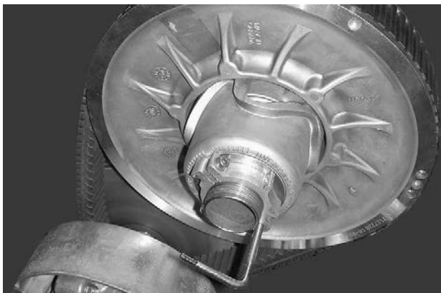
TYPEBILDE – FORLENGER FOR DRIVREIMSKIVE MONTERT PÅ JUSTERINGSNAV
