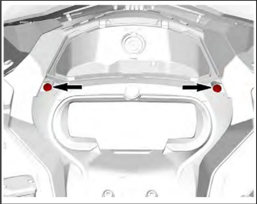
3. ゲージの正面を上げ、動かすために全面にスライドさせます。
