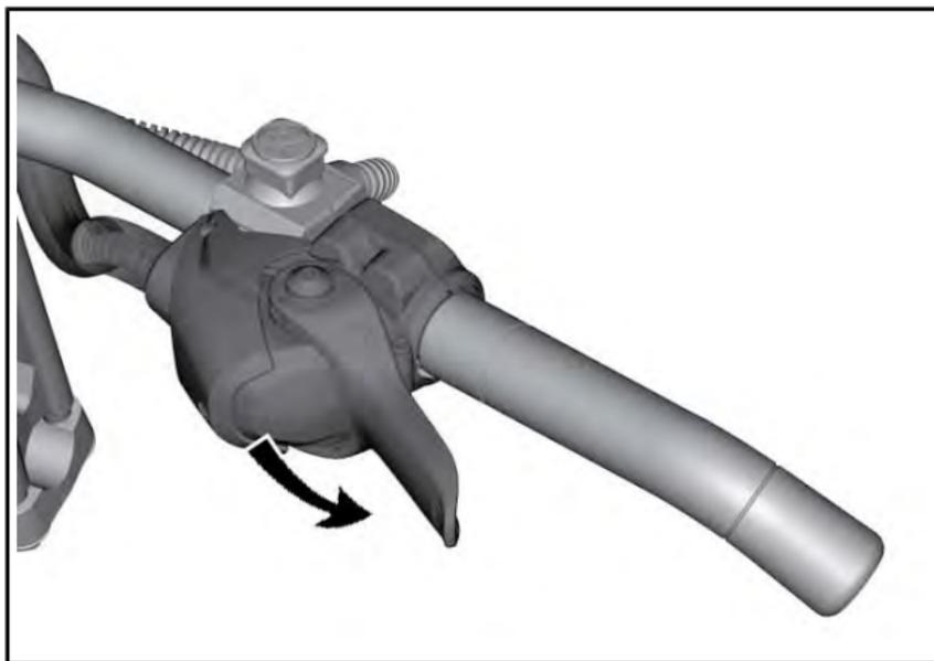
親指スロットルポジション：下方へ押ししてスロットルハウジングを回転させる
