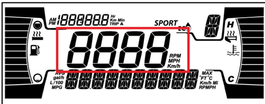
エンジンの回転数または車両速度（km/hまたはmph単位）を表示します。
