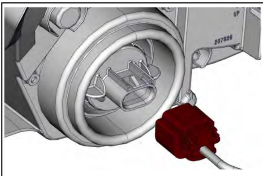
7. 電球を反時計回りに回して、ロック解除します。
