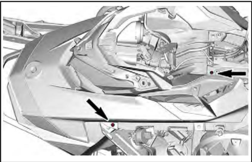
9. アッパーボディモジュールのリアエンドフックをコンソールのスロットから外します。
