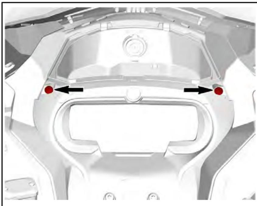
3. ゲージサポートの正面を上げ、前方にスライドさせて取り外します。
