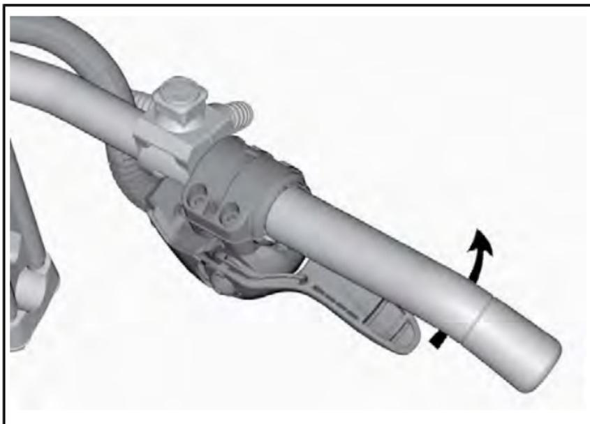
望む場合、スロットルハウジングを引き続き回転する
