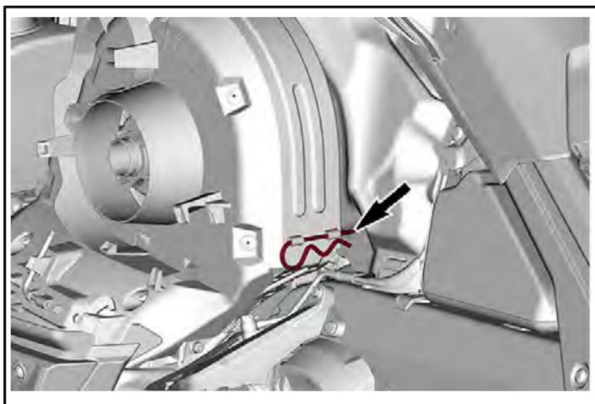
ガードの後部を持ち上げてから、フロントタブを外します。
