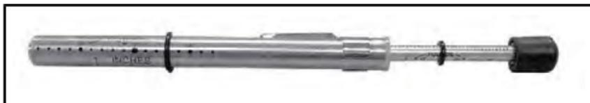
5. ボトムOリングを使用して、たわみを30 mm ~ 35 mmに設定します。
