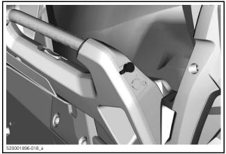
PASSENGER - ELECTRIC VISOR JACK CONNECTOR LOCATION
