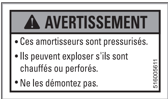
mmo2010-003-101_en ÉTIQUETTE 10 - SUR LES AMORTISSEURS À GAZ
