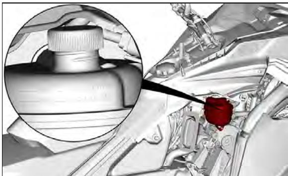
储液箱 - MIN 和 MAX 冷液位线
