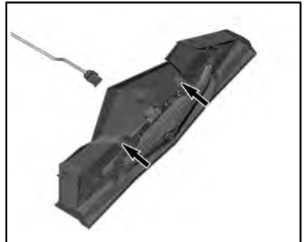
BOULONS DE RETENUE QUI FIXENT LE FEU ARRIÈRE AU SUPPORT DE FEU ARRIÈRE
