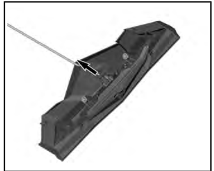
DÉBRANCHEMENT DU CONNECTEUR DE FEU ARRIÈRE
