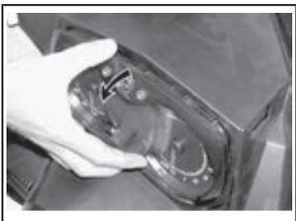
3. 切れたバルブのコネクターを外します。ラバーブーツを外す。
