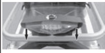
**注記** 配線への損傷を防止するために、テールランプハウジングを引き出し過ぎないように注意してください。
