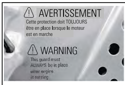
ÉTIQUETTE 9 - SUR LA PROTECTION DU DISQUE DE FREIN (MÉTAL NU)
