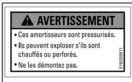
ÉTIQUETTE 10 - SUR LES AMORTISSEURS À GAZ
