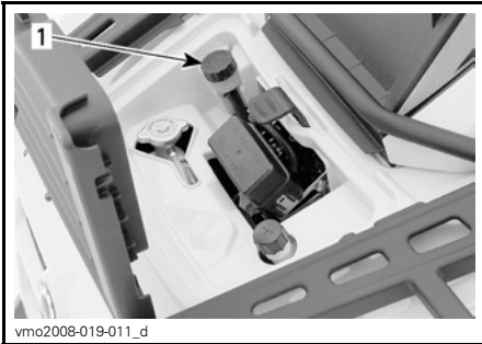
TÍPICO — COMPARTIMENTO DE ASSISTÊNCIA FRONTAL 1. Depósito
