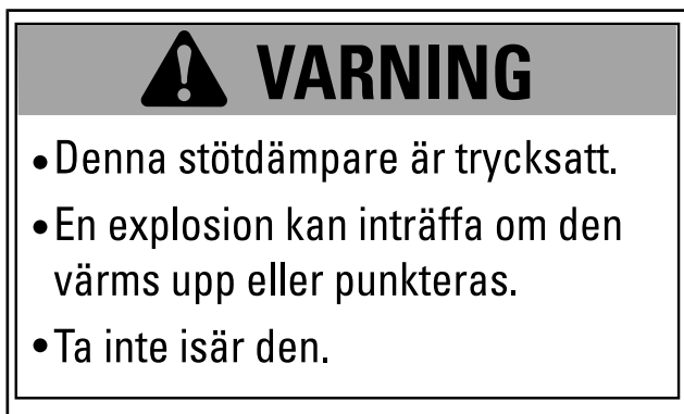
DEKAL 11 - PÅ GASFYLLDA STÖTDÄMPARE
