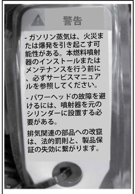
ラベル18- 燃料噴射器上 - E-TECモデル
