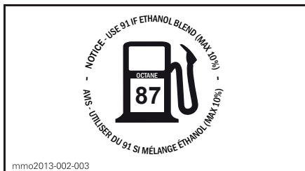
НА КРЫШКЕ ТОПЛИВНОГО БАКА - МОДЕЛИ 550 F, 600 ACE И 900 ACE (В СТРАНАХ, ИСПОЛЬЗУЮЩИХ АКІ ДЛЯ ОБОЗНАЧЕНИЯ ОКТАНОВОГО ЧИСЛА)
