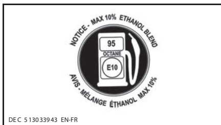
НА КРЫШКЕ ТОПЛИВНОГО БАКА - МОДЕЛИ 600 NO E-TEC (В СТРАНАХ, ИСПОЛЬЗУЮЩИХ ОЧИ (RON) ДЛЯ ОБОЗНАЧЕНИЯ ОКТАНОВОГО ЧИСЛА)
