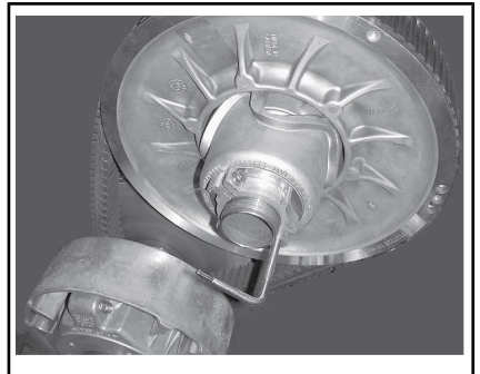
VARIAATTORIN AVAUSTYÖKALU ASENNETTUNA SÄÄTIMEN NAPAAN
