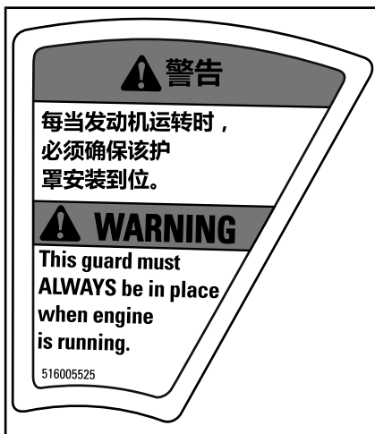
标签 12 - 位于制动盘护罩上 (上漆通道)
