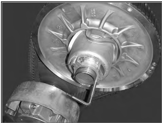
ТИПОВОЙ ВАРИАНТ — ПРИСПОСОБЛЕНИЕ ДЛЯ РАЗВЕДЕНИЯ ШКИВА ВСТАВЛЕНО В РЕГУЛИРОВОЧНУЮ МУФТУ
