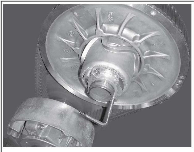
TYPIQUE - ÉCARTEUR DE COURROIE INSTALLÉ SUR LE MOYEU DE RÉGLAGE
