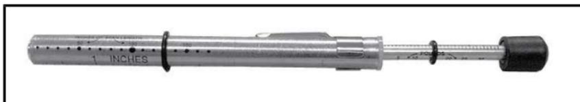
5. 使用底部 O 型圈将挠度设置到 30 mm and 35 mm 之间。
