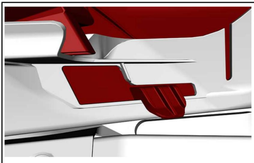
注释：确保进气管道在防尘套中正确定位。
