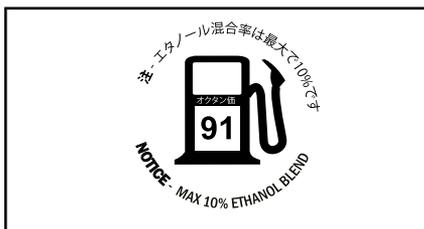
燃料キャップ上-E-TECエンジン-ポンプ表示アンチノックインデックス (リサーチオクタン価+モーターオクタン価) /2オクタン価を使用する国において
