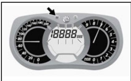
表示が点滅している間にセット (S) ボタンを押して、瞬間燃費モードを選択します。
