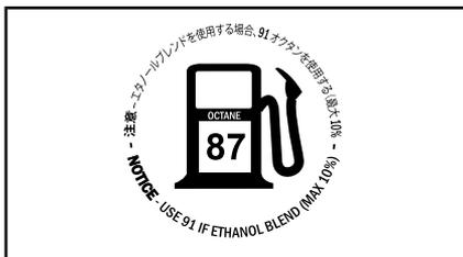
燃料キャップ上 - 1200 4-TECおよびACEエンジン - ポンプ表示アンチノックインデックス (リサーチオクタン価+モーターオクタン価) / 2オクタン価を使用する国において
