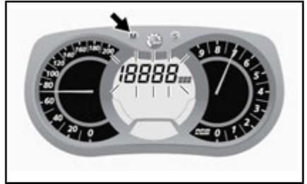
表示が点滅している間に、セット (S) ボタンを最長で5秒間押したままにしてリセットします。
