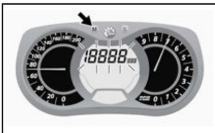
表示が点滅している間にセット (S) ボタンを押して、総燃費 (TC) モードを選択します。
