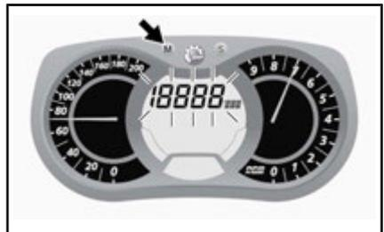
表示が点滅している間にセット (S) ボタンを押して、回転数モードを選択します。
