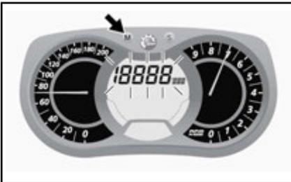
表示が点滅している間にセット (S) ボタンを押して、スピードメーターモードを選択します。
