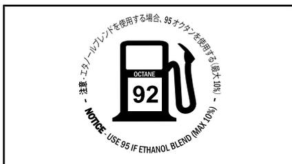
燃料キャップ上-1200 4-TECおよびACEエンジン-リサーチオクタン価を使用する国において
