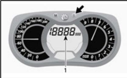
1. 車両の平均速度 (AVR\_SPD) モードモード (M) ボタンを押して選択内容を確認し、5秒間待ちます。
