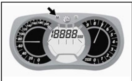
表示が点滅している間にセット (S) ボタンを押して、最高速度 (TOP\_SPD) モードを選択します。
