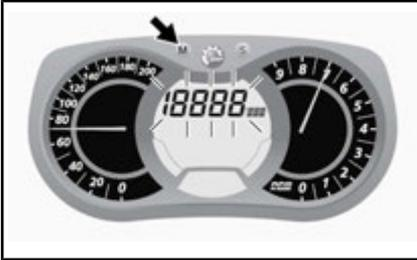
表示が点滅している間にセット (S) ボタンを押して、車両の平均速度 (AVR\_SPD) モードを選択します。
