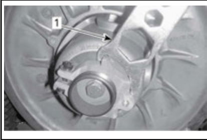
1. Outil de réglage de la suspension
