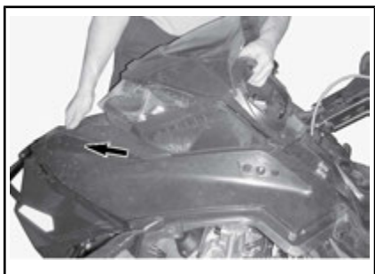
SKYV MOT FRONTEN
