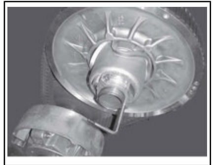
SCHEIBEN-EXPANDER AN NABE DER EINSTELLVORRICHTUNG MONTIERT
