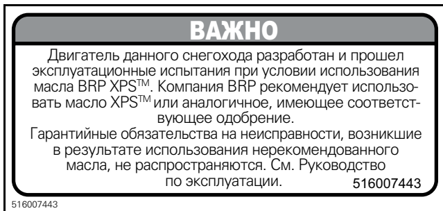
НА ПРОБКЕ МАСЛЯНОГО РЕЗЕРВУАРА
