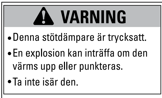
DEKAL 11 - PÅ GASFYLLDA STÖTDÄMPARE
