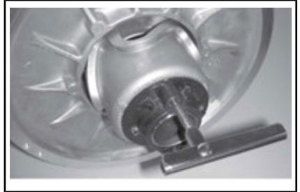
VARIATORNS UTVIDGARE INSTALLERAD PÅ JUSTERINGSNAV I PLAST
