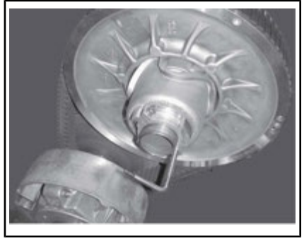
VARIATORNS UTVIDGARE INSTALLERAD PÅ JUSTERINGSNAV I ALUMINIUM
