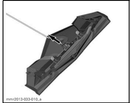
DÉBRANCHEMENT DU CONNECTEUR DU FEU ARRIÈRE
