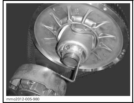
mmo2012-005-980 MANDRIN DE POULIE MENÉE INSTALLÉ SUR L'ANNEAU DE RÉGLAGE
